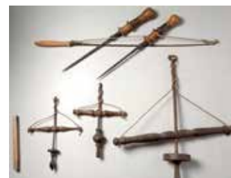
Foto 8. Esempi di trapani-torni ad arco.
