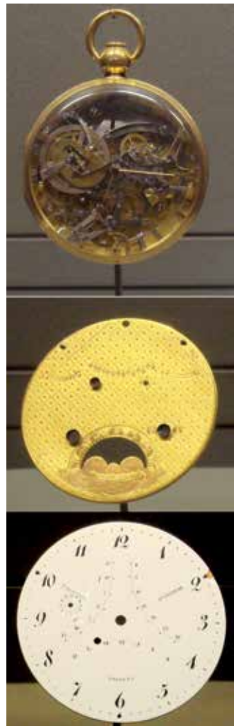
Foto 5. L'orologio di Abraham-Louis Breguet a doppio quadrante del 1785. Un quadrante per: ore, secondi, giorno della settimana, giorno del mese, mese dell'anno. L'altro ha mostra astrologica con fasi lunari e almeno altre 7 funzioni. Musée des arts et métiers Paris.
