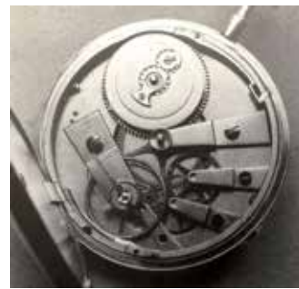
Foto 8. Movimento calibro 1 Lepine, 1820. Notiamo l'introduzione di ponti al posto della platina posteriore.
