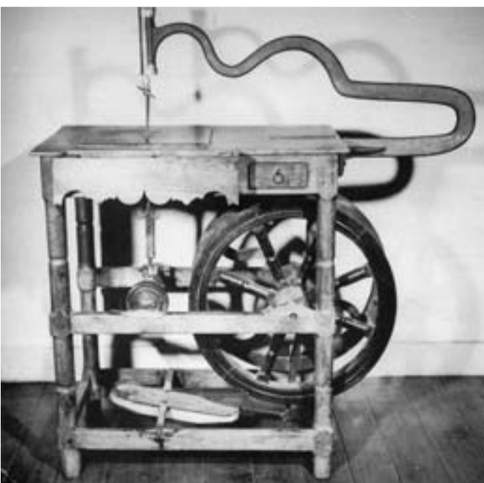
Foto 3. Sega alternativa a pedale, ricavata da un banchetto del Seicento. Questo tipo di sega entrò in uso nel Settecento.
