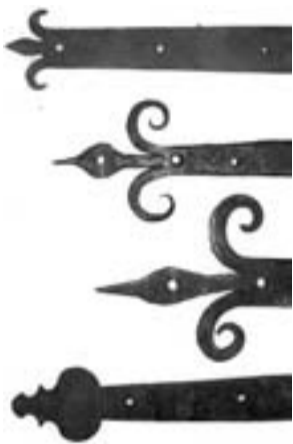
Foto 3, 4, 4 b, 4 c. Ferri decorativi. Bisogna notare che i fori per i chiodi non erano eseguiti con il trapano, ma con un forone, di norma con punta quadrangolare, battuto sul ferro incandescente; sul retro sono spesso ancora presenti le bave da esso provocate. La presenza di fori rotondi regolari implica l'uso del trapano, utilizzato molto dopo; anche la svasatura, ossia l'esistenza di una sede conica, che serve per accogliere le teste delle vite, è sintomo di ferri tardi. Proprietà dell'autore.
