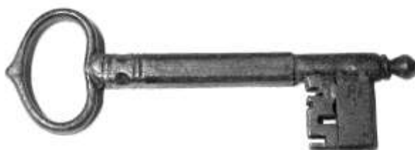
Chiave tra sei e settecento in cui la parte di dietro della mappa serve a superare gli ingegni e quella davanti a far avanzare il chiavistello; fucinata e limata.
