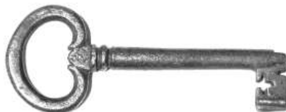
Chiave fucinata della metà del seicento, presenta un innesto a croce destinato a far ruotare l'intera bussola.
